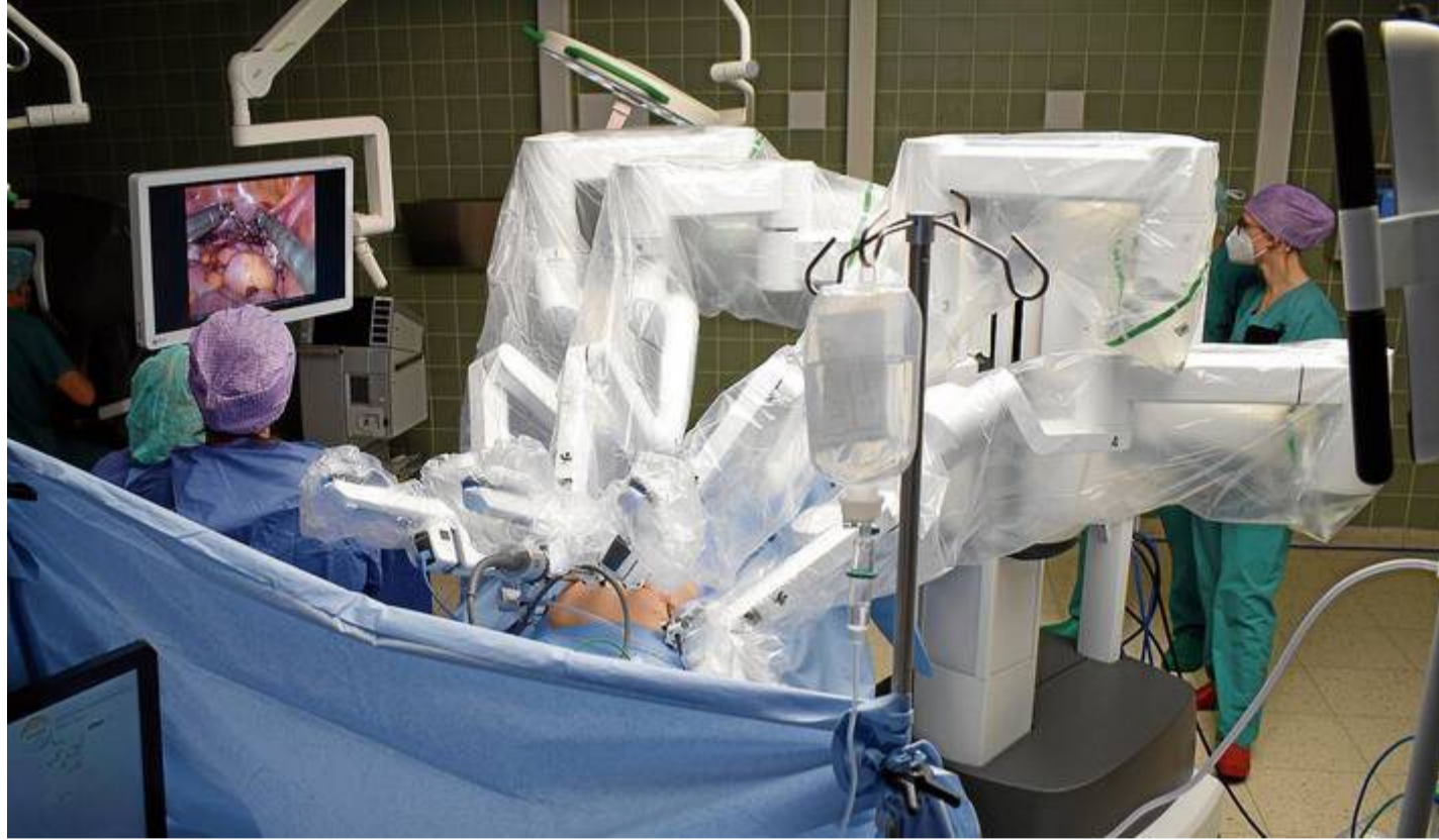
Vier Arme des Robotersystems erreichen durch die Bauchdecke der Patientin deren Gebärmutter.
